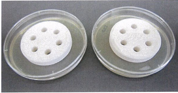
写真・2 試験の様子（制菌効果の評価試験） 左：①阻止円法 右：②菌液中への浸漬における効果試験
