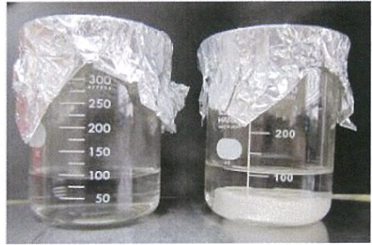
写真・2 試験の様子（制菌効果の評価試験） 左：①阻止円法 右：②菌液中への浸漬における効果試験
